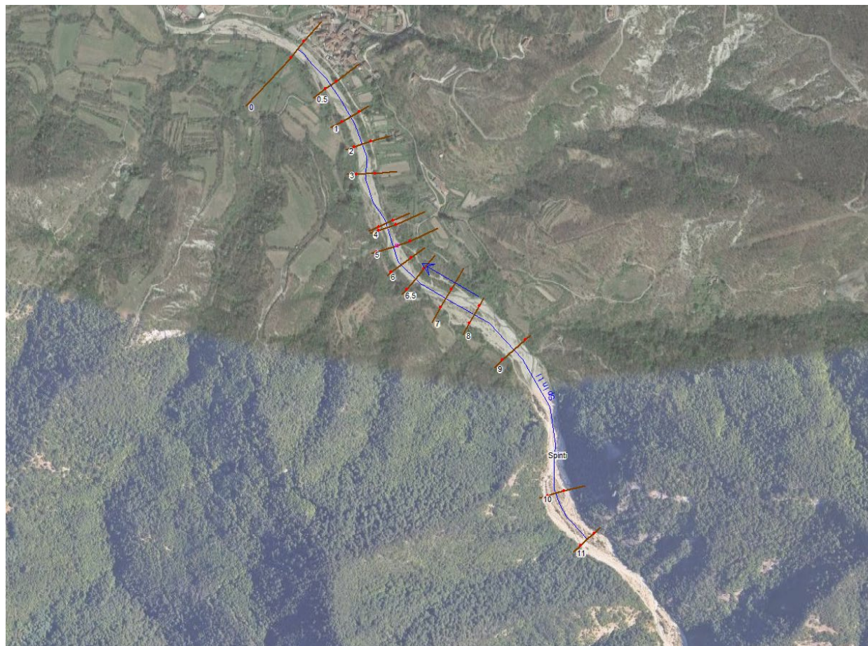
Figura 8 sezioni utilizzate per la modellazione idraulica ricavate dalla simulazione Hec-Ras.
